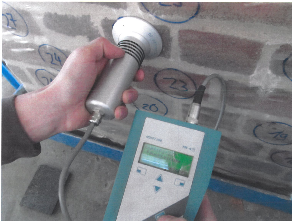
Bild 4 Messprinzip Feuchtemessungen mit Mikrowellenfeuchtemessgerät
