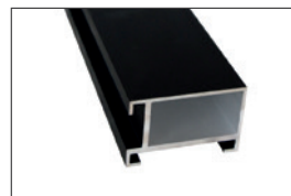
Aufbauhöhe 40 mm für die unsichtbare Befestigung von Holz- oder WPC-Dielen oder für die Verklebung von HPL- und Keramikbelägen, Feinsteinzeug, Fliesen u. v. m. Tragweite 95 cm.
