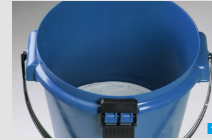
Spachteltrichter „Hopper“ mit pastöser Spachtelmasse füllen
