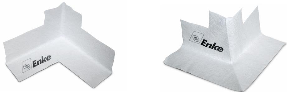
Auch an Rundungen empfiehlt sich der Einsatz unserer vorgefertigten Vliesmanschetten. Für eine handwerkliche Ausführung an runden Durchdringungen wird das Flächenvlies dem Durchmesser entsprechend ausgeschnitten, geweitet und als Kragen im waagerechten Bereich über die Rundung gestülpt. Am aufgehenden Baukörper wird nach entsprechendem Umfang ein Mantelvlies zugeschnitten, welches im Übergang zur Fläche ebenfalls gedehnt wird.
